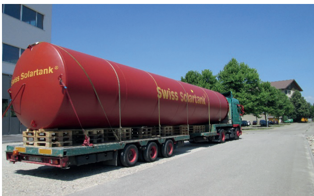
Abbildung 8: links: Transport eines grossen Wasserspeichers vom Werk auf die Baustelle per Sattelschlepper; rechts: Aufstellen der Speicher in Niedrigenergie-Solarhäusern in Deutschland (Bild: Jenni Energietechnik AG).
