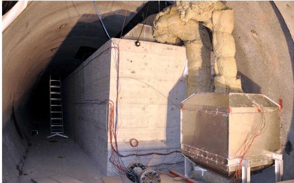
Beim Entladen des Druckluftspeichers läuft es genau umgekehrt: Aus dem Hohlraum strömt die Druckluft zuerst durch den sensiblen Speicher, danach durch den Latentwärmespeicher. Weil die Temperatur beim Erstarren der Metallschmelze im Latentwärmespeicher konstant bleibt, sorgt dieser für eine Stabilisierung der Temperatur der ausströmenden Luft. Auf diese Weise können die Turbinen, die wiederum Strom produzieren, effizienter arbeiten.
